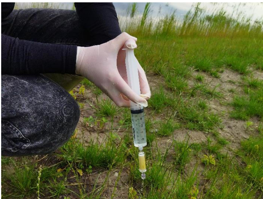
Fot 1. Filtrowanie wody przez filtr strzykawkowy.
